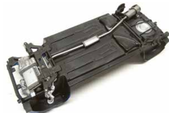
Onderzijde chassis met gemonteerd motorblok, uitlaat en stuurinrichting.
