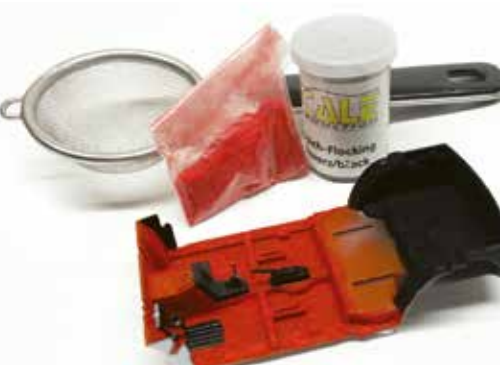
Het interieur wordt bestrooid met rode tapijtvlokken nadat eerst de bodemplaat in het rood is gespoten.
